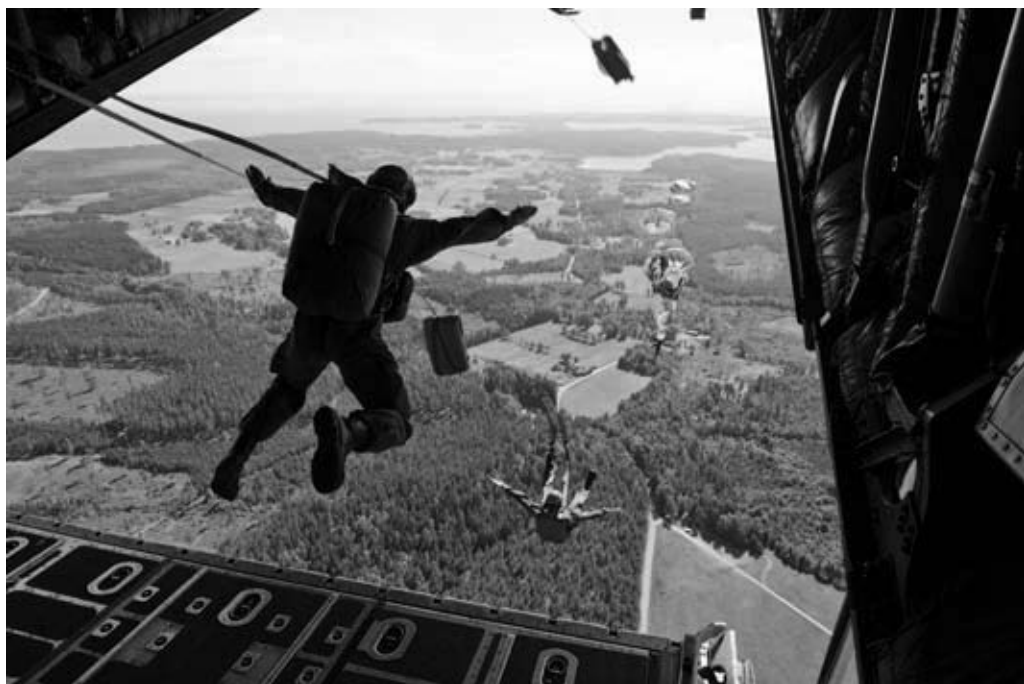
Bild: Kadetter ur Officersprogrammet 13-16 (222 qzrn) genomför sitt första fallskärms hopp med automatutlöst rundkalottsfallskärm över Flugebyn utanför Karlsborg i augusti 2015. Utdragsremmarna som drar ut fallskärmen då hopparen lämnar flygplanet är tydligt synliga. Uthoppshöjden är cirka 400 meter. Foto: Jimmy Croona, Combat Camera/Försvarsmakten
