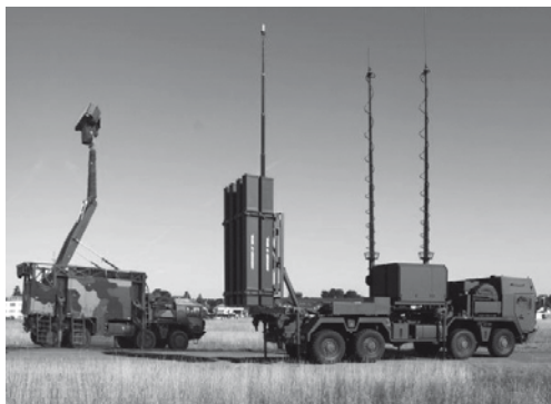
Bild 3: IRIS-T SLM har samma konceptuella sammansättning som IRIS-T SLS men räckvidden är ca 15 km och höjdtäckningen ca 10km. Det borde vara möjligt att skjuta robotar med olika räckvidd från samma robotfordon. Kanske kan ett liknande koncept användas även med PAC-3 mot ballistiska robotar om måldata kan överföras från t ex FSR 890.
