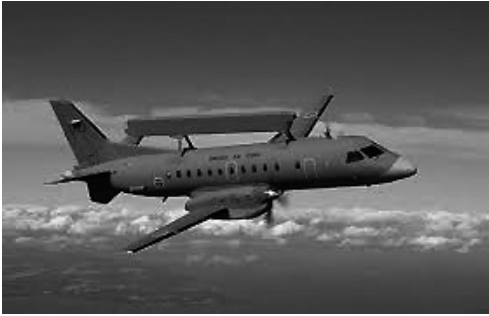
Bild 4: Jordrundningen är ett bekymmer för luftvärn med lång räckvidd på land och till havs. Flygande radar är ett sätt att se mål på lägsta höjd långt bort.
