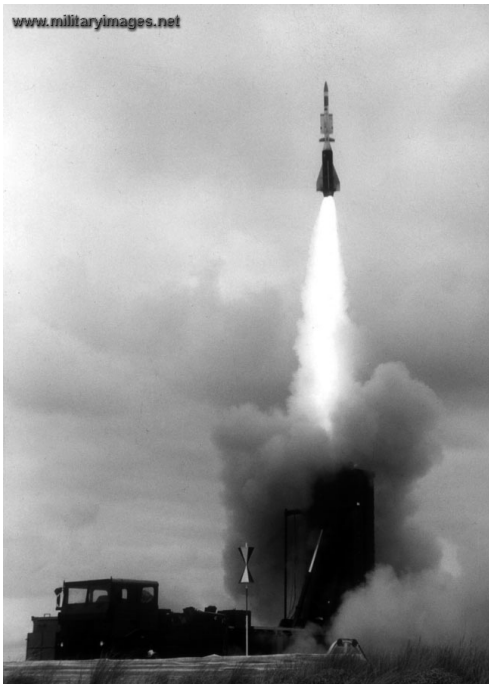
Bild 1: Franska Aster 30 SAMP/T är ett exempel på luftförsvarsluftvärn som kan bekämpa alla aktuella typer av mål inklusive ballistiska robotar från marken eller från fartyg. Räckvidd: 3-120 km. 5
