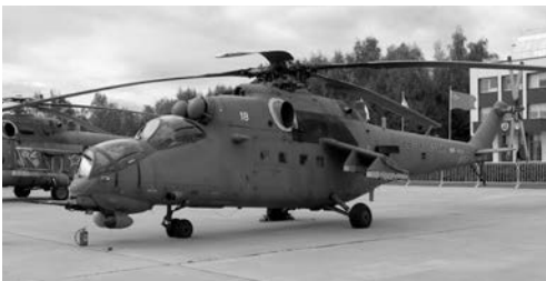
Bild 2. Mi-35M. Anmärkning: Notera X-tail stjärtrotor samt de kortare vingarna. Bild: FMV.
